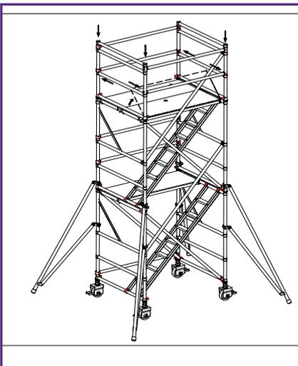
Remontez le **PLATEAU FIXE** pour le positionner sur le premier barreau du **GARDE-CORPS**, en positionnant le crochet anti-soulèvement entre le cadre et le garde corps.
